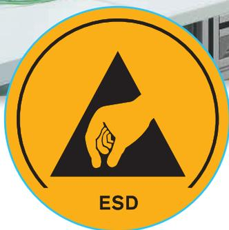
**Die Ursache für ESD sind elektrische Aufladungen, die durch Ladungsmengen infolge von Reibungsaufladung an unterschiedlichen Materialien oder infolge von Influenz in elektrischen Feldern erzeugt werden. Hierbei können Spannungen bis über 10 000 V entstehen.**
