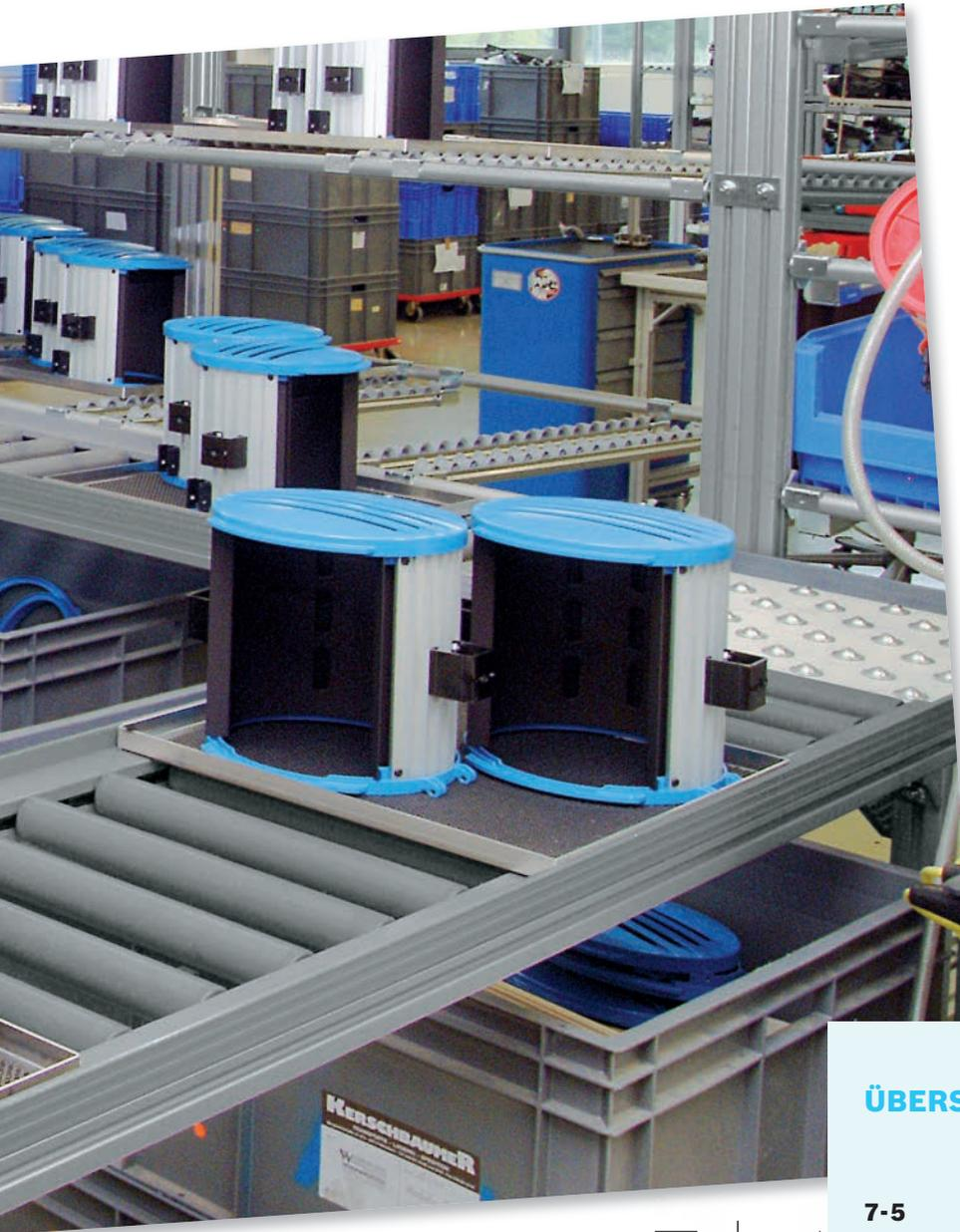
Die Förderbahnen können Sie fertig montiert beziehen oder aus einzelnen Komponenten aufbauen. Verschiedene Fördermedien erlauben es Ihnen, die Förderbahnen optimal auf Ihr Fördergut abzustimmen: Kartonagen und Blister transportieren Sie auf durchgehenden Kunststoff- oder Stahlrollen, als Alternative stehen Ihnen Gleitstrecken zur Verfügung. Aufgrund seiner hohen Stabilität ist EcoFlow auch für den Einsatz bei schweren Lasten geeignet.
