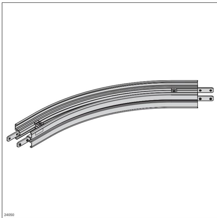
Die Gleitkurve dient der horizontalen Richtungsänderung der Kette, wenn der Bauraum für ein Kurvenrad nicht ausreicht oder die Geschwindigkeiten oder Produktabmessungen einen Transport über das Kurvenrad nicht zulassen. Die Gleitkurve wird zur Geräuschreduzierung bei hohen Geschwindigkeiten oder beim Transport von langen Produkten im Klemmförderer eingesetzt. Durch die auftretende Reibung erhöht sich die Kettenzugkraft. Anbaumöglichkeiten siehe Matrix auf Seite 313
