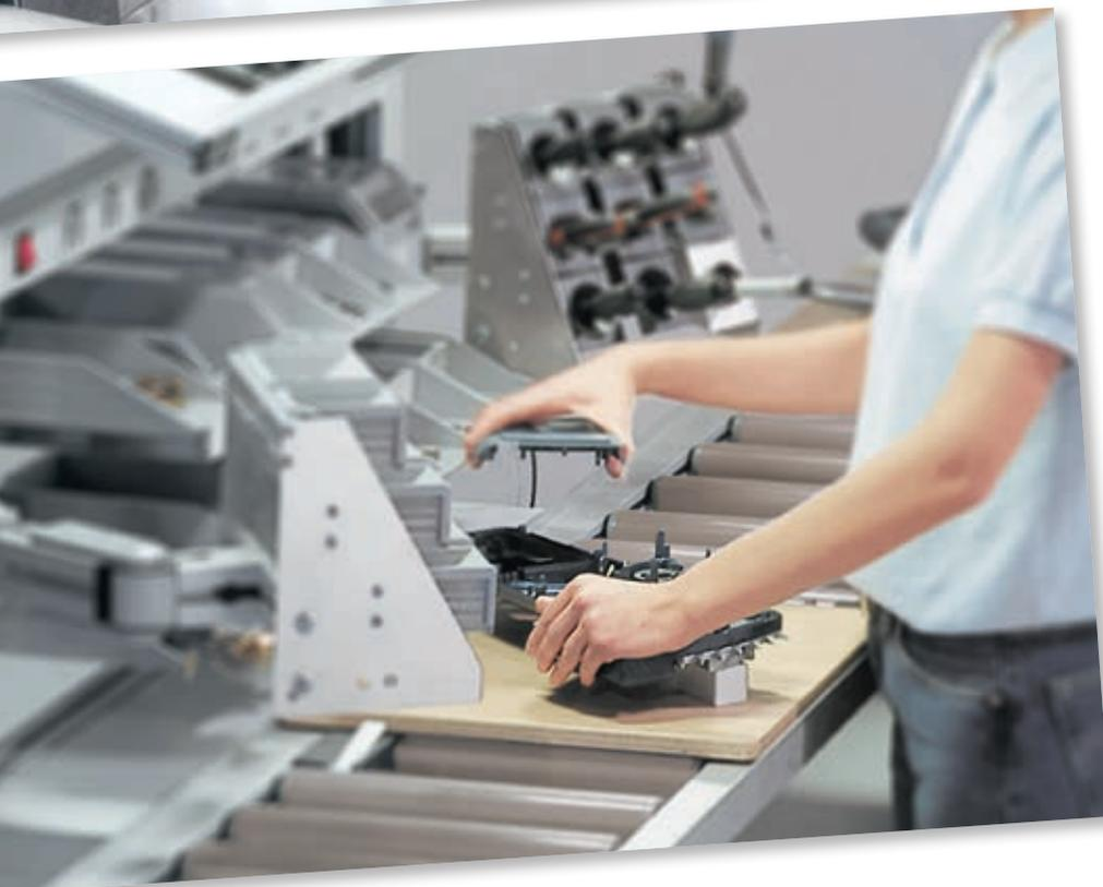
Manuelle Produktionssysteme von Rexroth sind von Grund auf für die Realisierung einer schlanken Produktion konzipiert. Mit ihren drei Säulen Arbeitsplätze, Materialbereitstellung und Vernetzung folgen die Manuellen Produktionssysteme einem ganzheitlichen Konzept, das voll und ganz auf Effizienz und die Vermeidung von Verschwendung ausgelegt ist.
