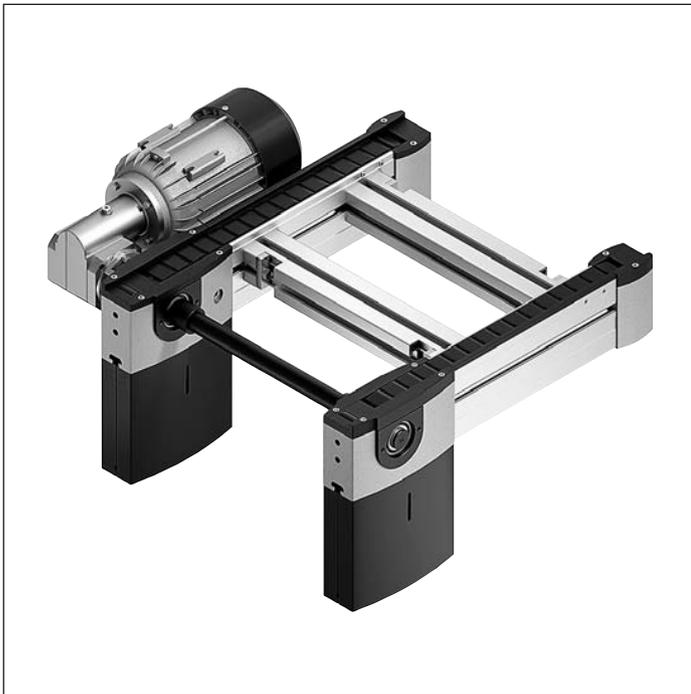
Mit der Flachplattenkette werden vorzugsweise mittlere und große Werkstückträger in einer gering bis mäßig durch Fertigungsemissionen belasteten Umgebung befördert. Die Bogenlauffähigkeit der Kunststoff-Flachplattenkette erlaubt durchgehende Antriebskombinationen mit Kurvenbögen (s. S. 4-32).
