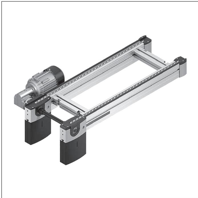
Die Bandstrecke ist eine funktionsbereite Förderstrecke mit eigenem Antrieb zum Transport von Werkstückträgern in Längsrichtung oder zum Quertransport des Werkstückträgers zwischen parallelen Förderstrecken in Verbindung mit zwei Hub-Quereinheiten HQ 2.
